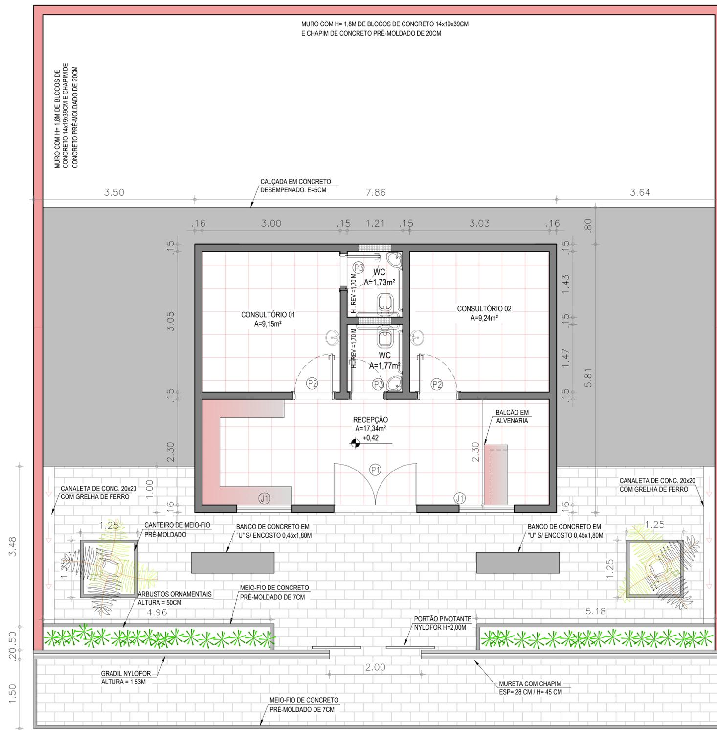
CONSULTÓRIOS – DEMOLIÇÃO DE TODO O PISO, EXECUÇÃO DE UM RADIER DE CONCRETO ARMADO COM DUAS MALHAS DE AÇO CA-50 5.0MM (POSITIVA E NEGATIVA) COM ESPAÇAMENTO DE 15CM NOS DOIS SENTIDOS. EXECUÇÃO DE CONTRAPISO DE REGULARIZAÇÃO, ASSENTAMENTO DE REVESTIMENTO CERÂMICO 50x50CM OU SUPERIOR, EMASSAMENTO DAS PAREDES, PINTURA DE PAREDES, LAJE E ESQUADRIAS, ILUMINAÇÃO EM LED.
